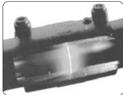
Şekil 7: Kaynak anında kaynak bölgesi
